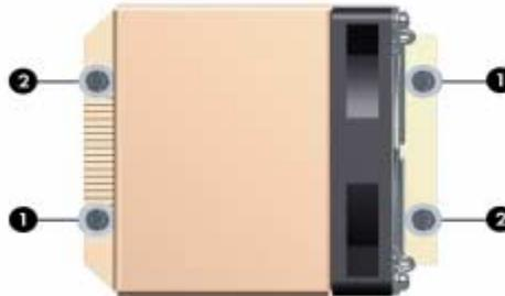
図 5 ヒートシンクのねじ締め
